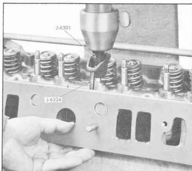
Fig. 15 Rocker Arm Stud Installation
